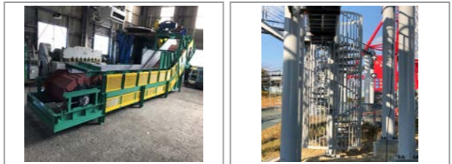
鉄製品及び溶接構造の治具 螺旋階段製作
