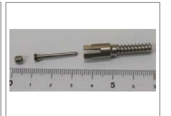
脊椎インプラント試作品 材質 Ti-6Al-4V
