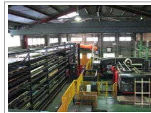
自動倉庫付きレーザー複合機ライン
