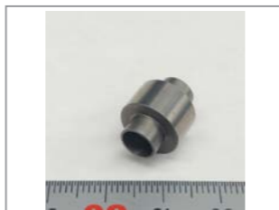
純タングステン旋盤加工 (外径±4μ粗さ0.4Ra)
