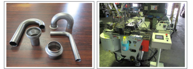
自動車部品 (180°曲げ※シワ無し) ベンダー機 (チヨダ RB75 型)
