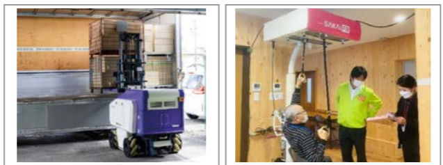
フォークリフトを自動化したAGV「Auto Lift」 フレイルマシーン
